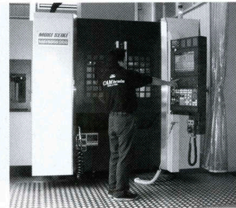
図2 当社の5軸加工機は「NMV 5000 DCG」(森精機製作所)、「SuperMILLER 400」(森精機製作所)、「MAM 72-35 V」(松浦機械製作所)、「NV 5000 α 1 A/40」(森精機製作所＝テーブル軸付加)、「ROBODRILL」(ファナック＝テーブル軸付加)でラインアップ。計13台がほぼ24時間フル稼働している。 写真はこの4月に導入した32バレットの松浦機械製作所製「MAM 72-35 V」(写真・左)と、日本一早く導入(モニタ導入)した森精機製作所製の最新高精度立形5軸マシニングセンタ「NMV 5000 DCG」(写真・右)。
